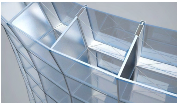
Abbildung 9: Detail einer Mehrschichtkonstruktion, die auf einem konischen Netz basiert. Eine Schicht folgt dem Netz, eine zweite folgt einem dazu parallelen Netz in konstantem Fläche-Fläche-Abstand.
