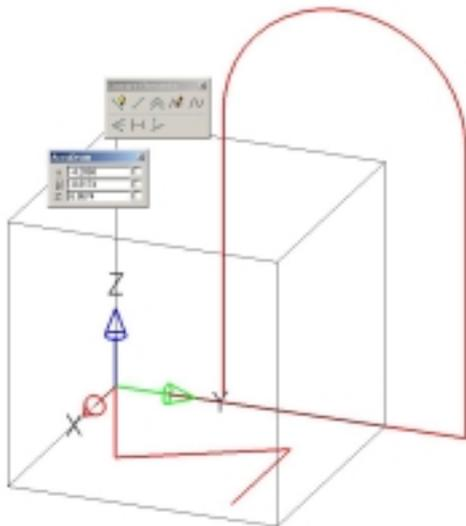
Unter Verwendung von AccuDraw platzieren wir einen Linienzug mit einem Halbkreis: Vom Ursprung 13 in y-Richtung, 11 in z-Richtung, Halbkreis mit Radius 9, -10.75 in z-Richtung.
