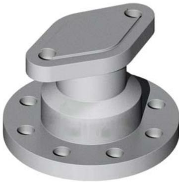
Der untere Teil des Flansches besteht aus Zylinder- und Drehkegelstücken, die laut Angabe platziert werden können. Die zylindrischen Bohrungen können mit Hilfe einer Matrix modelliert werden.
