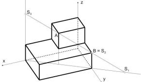
d) Hinweis: Durch die Bestimmung der 1. Spurpunkte von AB und BC erhält man die 1. Spur. Da A selbst ein 3. Spurpunkt ist, ergibt sich zusammen mit dem Schnittpunkt der 1. Spur mit der x-Achse sich die 3. Spur. Die Schnittpunkte der bereits konstruierten Spuren mit den Koordinatenachsen liefern die 2. Spur.
