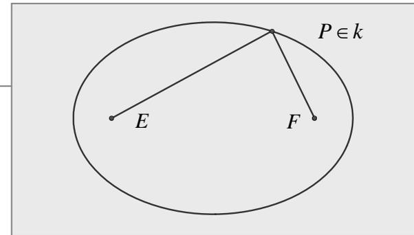
2. Die Brennpunkte lassen sich räumlich als Berührungspunkte der DANDELIN-Kugeln mit der Schnittebene der Drehkegelfläche deuten.
