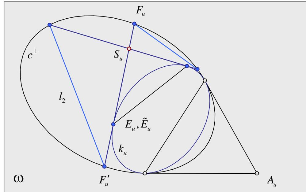
Die Kurve  $k_2$  berührt für die gewählten Lagen des Trägers  $s_u$  des schneidenden Ebenenbüschels  $E_{s_u}$  den uneigentlichen Kegelschnitt  $k_u$  der Drehkegelfläche doppelt.
