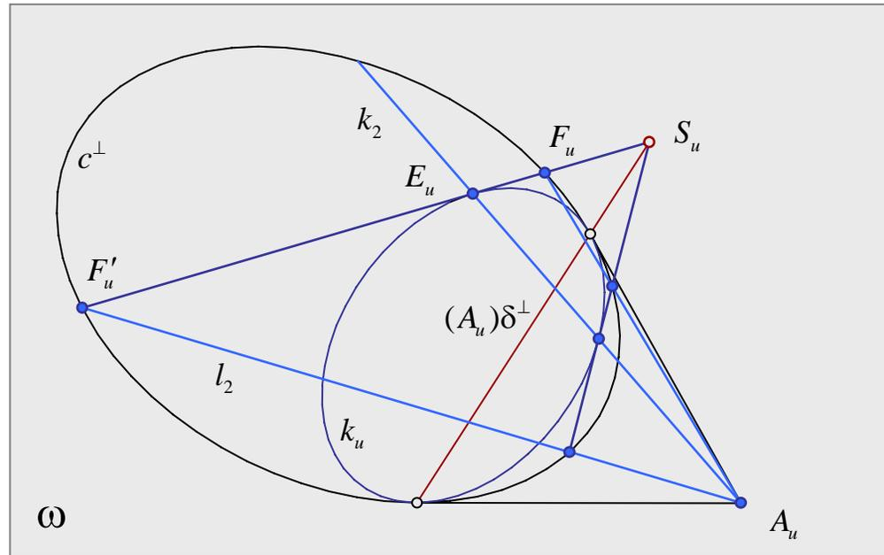
Der uneigentliche Punkt  $A_u$  der Achse  $a$  ist ein vierfach zu zählender Punkt der Kurve 4. Ordnung. Sie zerfällt in eine doppelt zu zählende Gerade  $k_2$  (absolute Polare zu  $S_u$ ) und ein Geradenpaar  $l_2$  über  $\mathbb{C}$ .
